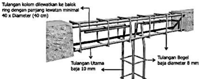
Gambar III.28 Hubungan Antara Kolom dengan Balok Keliling/Ring
