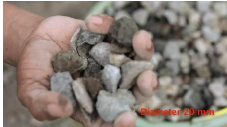
Gambar III.4 Diameter Kerikil yang Baik untuk Campuran Beton
