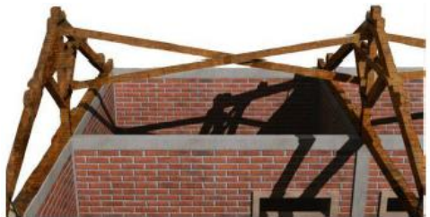
Gambar III.19 Ikatan Angin Sebagai Pengikat Antar Kuda-Kuda Kayu
